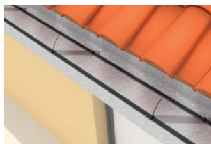
Abstandhalter bei der Doppelverlegung des Dachrinnenheizbandes.
