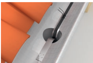
Kantenschutz am Fallrohr zur Zugentlastung.
